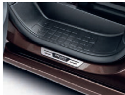
EINSTIEGSLEISTEN Die Einstiegsleisten aus Aluminium für den Proace Verso Electric bieten besten Schutz beim Ein- und Ausstieg.
